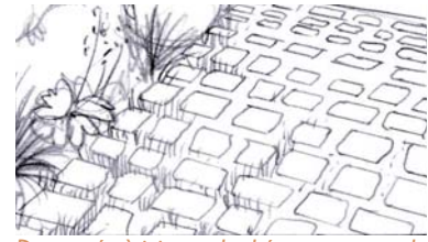
Des pavés à joints enherbés permettent de circuler librement tout en gardant un aspect vert et naturel.
