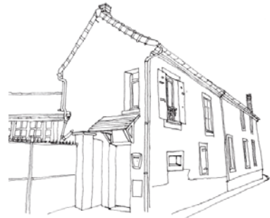
La maison rurale est implantée parallèlement à la rue. Désaxées par rapport à l'axe du faîtage, des ouvertures sont parfois percées sur le pignon
