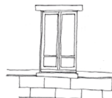
Les tableaux des fenêtres sont traités de la même façon que le mur de façade, simplement rejointoyés s'ils sont en pierre de taille, éventuellement badigeonnés, enduits s'ils sont en moellon
