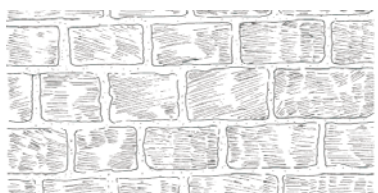
Mur en pierre calcaire layée. Aspect du parement composé d'ensemble de stries uniformes laissées par un outil appelé laye à la surface de la pierre
