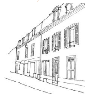
Les maisons de bourg s'élèvent parfois sur deux niveaux. Les combles sont éclairés généralement sur les versants de toiture
