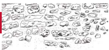
Maçonnerie en moellon non appareillé, rejointoyé au nu de la pierre
